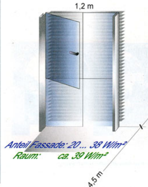
Bild 3: Zuordnung Kühllast zum Raum und zur Fassade
